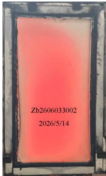
照片 2 耐火试验结束时试件情况
